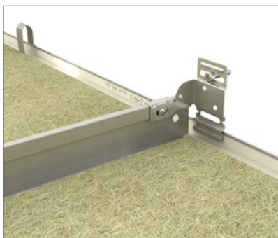
For å sikre at Rockfon System T24 X er montert korrekt og kvadratisk, anbefales det å benytte et vegg- og overgangsbeslag på hver bæreprfil og annenhver tverrprofil.
