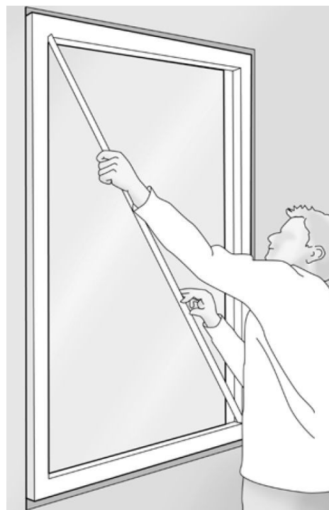
Fig 19. Diagonalmål skal være like, det indikerer riktig montering.
