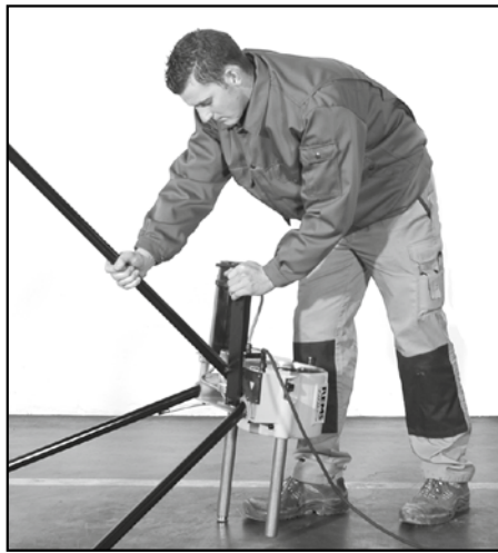
Fig. 1: RohrfüÙe einstecken Fig. 1: Inserting the tubular legs Fig. 1: Engager les pieds tubulaires Fig. 1: Infilare le gambe di supporto Fig. 1: Introducir las patas tubulares Fig. 1: Steunpoten insteken Fig. 1: Isättning av benen Fig. 1: Montering av rørben Fig. 1: Indstikning af rørben Kuva 1: Putkijalkojen asennus Fig. 1: Introduzir os pés tubulares Rys. 1: Montaż nóżek rurkowych Obr. 1: Trubkové nohy nastrčit Obr. 1: Rùrkové nohy nastrčit 1. ábra: Feltolni a csólábakat Sl. 1: Utaknuti noge od cijevi Slika 1: Vstavite cevno podnožje Fig. 1: Introducereea picioarelor tubulare Фиг. 1: Вставить трубные ножки Εικ. 1: Τοποθέτηση των σωληνωτών ποδιών Resim 1: Boru tipi ayakların takılması Фиг. 1: Постановяне на тръбните стойки 1 pav.: Vamzdinių kojų įstatymas Att. 1: Ievietot caurules galus Joonis 1: Torujalgade sissepanek
