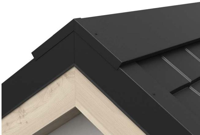
Tilpass siste profil til mønelengden og avslutt med Vinkelmøne Endestykke. Klippes og tilpasses riktig takvin kel. Fest med to skruer.
