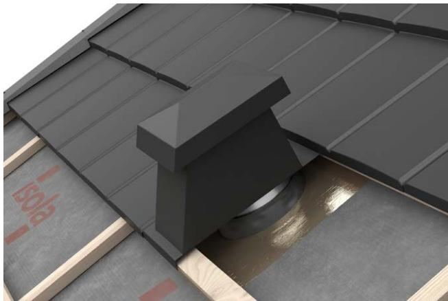
Plassering av takhatten avgjøres av lekter og plateforskyvning. Hullet tilpasses takhattens modul slik at det oppnås riktig sideomlegg. Hullet og rørgjennomføringen forsegles til undertaket med Isola Takmansjett eller Isola FlexWrap. Plano skal alltid ligge med omlegg over ventilasjonshettens flenser, på siden og i bakkant. Platen kuttes slik at omlegget dekker takhattens riller og ned i profil.
