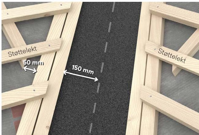
Mål 150 mm ut fra senter av kilrennen til hver side. Snorslå to parallelle linjer i lengderetningen. Monter to sløyfer langs disse. Montér deretter to nye sløyfer ca 15 mm på yttersiden av disse. Takets øvrige sløyfer avsluttes ca 50 mm fra de ytterste kilrennesløyfene.
