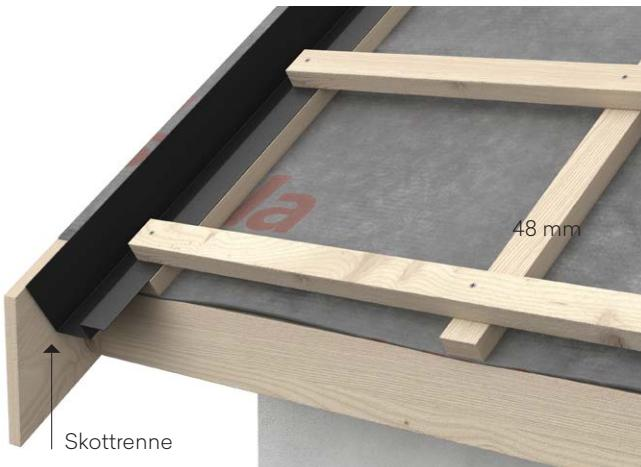
Minste anbefalte sløyfedimensjon 30 x 48 mm. Avslutt sløyfer 72 mm fra vindskiborets innside for riktig plassering av skottrenne. Alle tilbehørsbeslag er tilpasset minimum 30 mm sløyfehøyde. For diffusjonsåpne undertak skal sløyfehøyden være i henhold til tabell 2.
