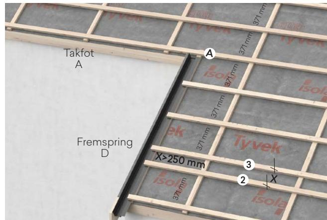
På tak med fremspring må alltid øverste takfot (A) benyttes som retningsgivende for inndeling av platelekt med 369 mm lekteavstand for hele taket. Dersom lekteavstanden på fremspring D ikke kan deles inn i 369 mm, må justering skje mellom lekterad 2 og 3 med avstand X. Denne avstanden må ikke være under 250 mm. Er avstanden mindre enn 250 mm fordeles justeringen på to rader.
