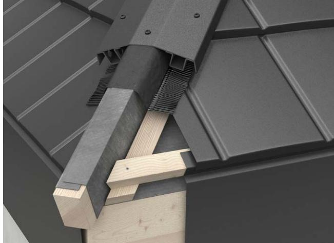
Tilpass høyde på valmkam i forhold til Valm profilen og monter deretter undertaket. Monter sløyfer og lekter inntil valmkam. Avslutt vertikale sløyfer ca 50 mm fra sløyfe langs valmkam. Monter plater med ca 20 mm avstand inn mot valmkam. Monter deretter mønelufteterbånd over valmkam og ned mot platene. Deretter festes Vinkelmøne til bærelektene med medfølgende skruer.
