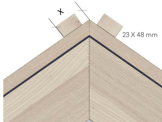
Det anbefales lektedimensjon på 30 x 48 mm. En del av beslagsløsningene er tilpasset denne dimensjonen. Maksimal lektebredde er 48 mm. Øverste lekt mot mønekam anbefales i dimensjon 23 x 48 mm.
