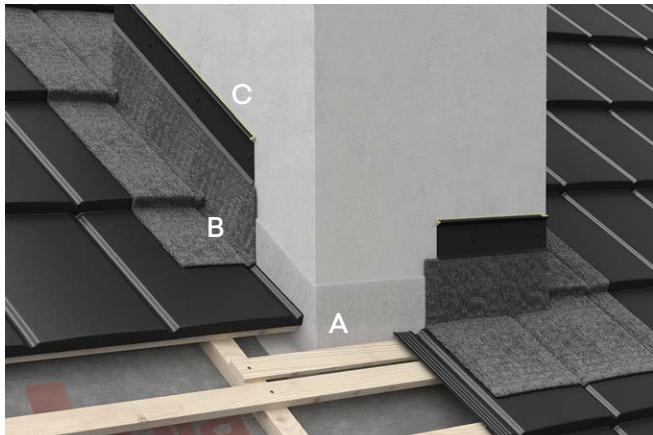
Overgangen mellom pipestokken og undertaket forsegles med Isola FlexWrap (A). Avslutt Plano så nært pipestokken som mulig. Nedre del av pipestokken primes med Isola Primer. Isoflex P (B) klebes 15 cm ut på Plano platen og 15 cm opp på pipestokken (primet). Et avslutningsbeslag (C) felles inn i pipestokken og dekkes over Isoflex P med 5 cm.
