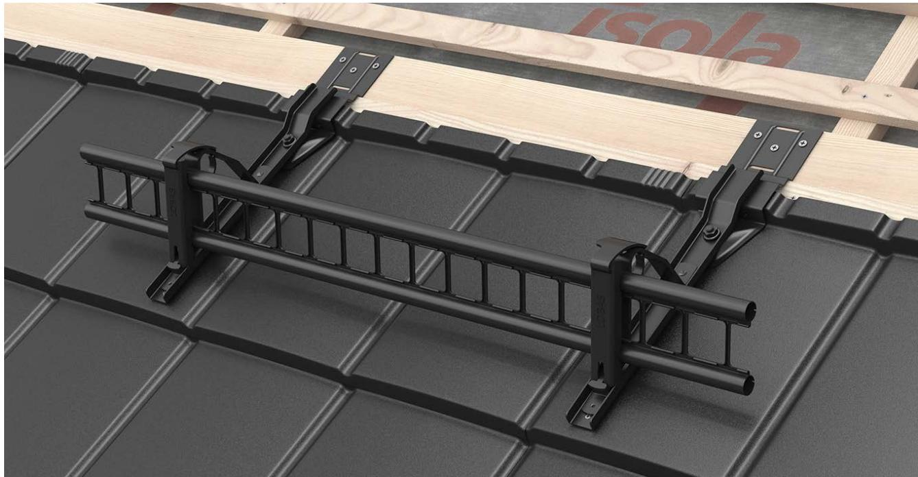
Montér låseklemmene på konsollene. Sett gelenderet så langt ned i konsollen som mulig, start fra en ende og kople sammen fortløpende. Vipp låseklemmen over og presses ned i firkanthullet. Gi den ett slag slik at den låses.
