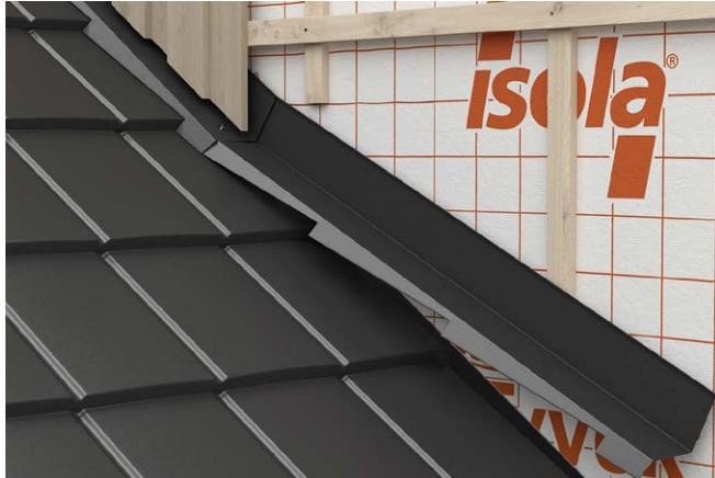
Platene legges inn mot senter av skottrenne i overgangen mellom tak og vegg. Fest plater og deretter overgangsbeslag Tak/Vegg. Dette festes til sløyfer.
