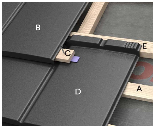
Det må alltid benyttes en støttelekt (A) på raden hvor fremspringsjusteringsplaten (B) skal monteres. Høyde på bærelekt (E) må tilpasses fremspringsplatens posisjon. Understøttelse lekten (C) festes ned i sløjfene i riktig posisjon på plate (D). Fremspringsjusteringsplaten festes med fire skruer fra oversiden og ned i bærelekten (E). Skruer forsegles.
