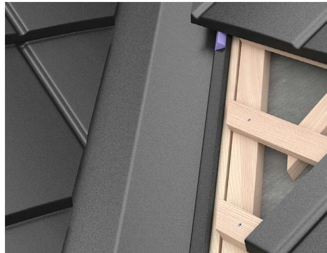
Powertekkplaten avsluttes inn i kilrennen med en overlapp på ca 20 mm. Snorslå en linje på hver side, målt 20 mm inn på kilrennebeslaget. Mål avstanden fra senter av siste Powertekkplates omlegg i overkant og underkant inn til snorslått linje i kilrenne.
