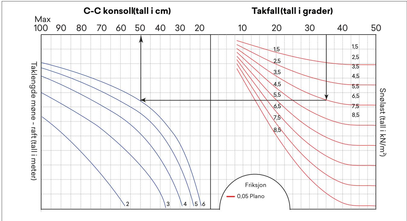
Takvinkel, friksjonskoeffisient og snølast avgjør bredden mellom konsollene. Benytt diagrammet under og ta ut maksimal konsollavstand. Festebriketten skal monteres i det flate partiet i øvre del av platen.
