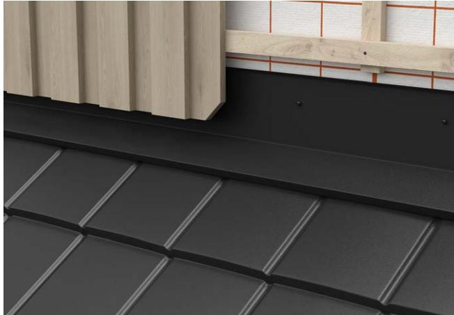
Avslutt Powertekk Plano så nær veggen som mulig. Monter skumplastkile, eventuelt bruk Isoflex eller FlexWrap i overgangen langs hele lengden av veggens. Monter Overgangsbeslag front til spikerslaget i veggens, husk omlegg på 50 mm. Forsegles til vindsperren med Isola Tyvek Vindsperre Tape.
