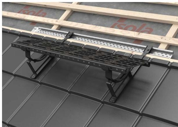
For sikker innfesting av feieplatå monteres først en godkjent festeskinne ned i bærende konstruksjon og deretter festes en konsollbrakett til festeskinnen. Feieplatå monteres tilslutt til konsollbraketten. Se egen monteringsanvisning.
