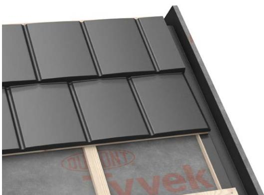
Øverste platerad kappes langsetter øverste lekterad og festes med to skruer i bakkant og 4 i forkant pr. plate.
