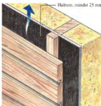
Figur 3: Min. 25 mm ventilert hulrom (Treinformasjon, Tre 55)
