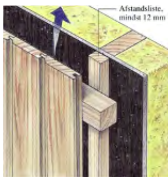
Figur 2: Min. 12 mm ventilert hulrom (Treinformasjon, Tre 55).
