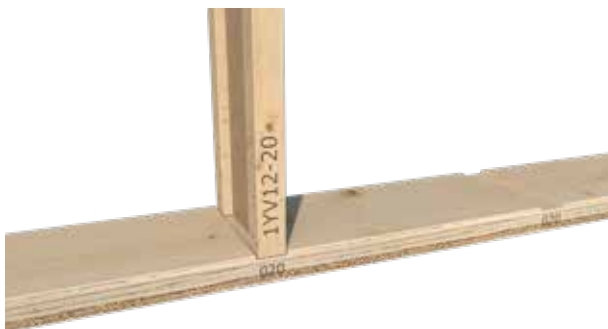
Merking av stender og KertoQ/rektangulær svill, med sliss i svill.
