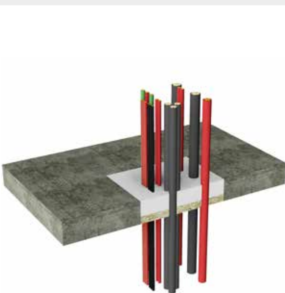
Figur 7. Tykkelse: 100 mm GPG og 50 mm steinull
