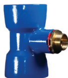
S-9121 Dobbeltmuffe m/Esco Lock* Bajonettkobling i avsinkningsfri messing Med 2 " utv og 1 1/2 innvendige rørgjenger
