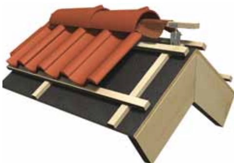
Bilde 10. Det er viktig at møne og valmtetningsrullen ikke ligger mot sidene på mønekammen, kun på toppen. Da får du best utluffing.
