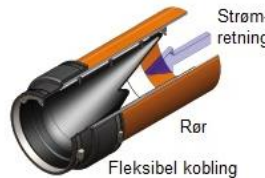
Montering på utløp vha fleksibel kobling.
