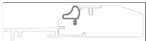
Thermokonstruksjon, U-verdi 0,57-0,98. Dørblad 86 mm.
