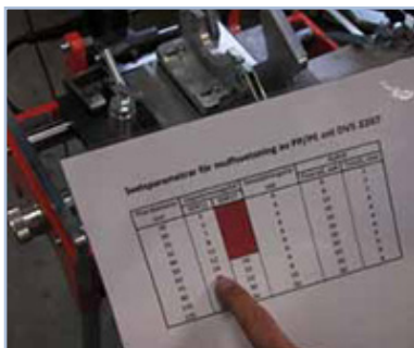
Kontroller sveiseparametrene iht. DVS 2207
