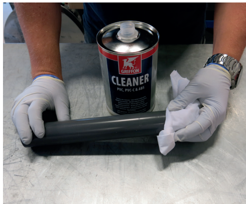
Rengjør rør og rørdel.
