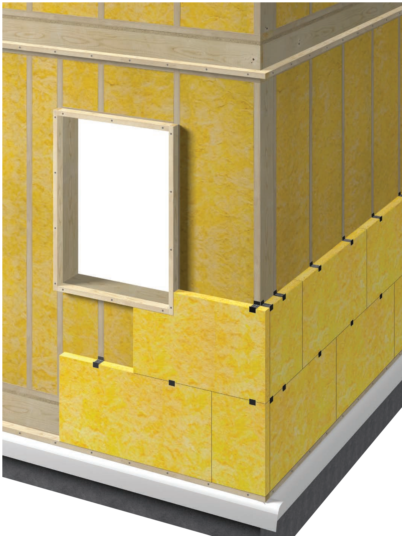
Veggplate 31 og veggplatebraketter på plass
