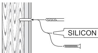
Vid montering på regelvägg med skivor måste väggen alltid förstärkas. Alla skruvfästningar skall ske i massiv konstruktion, t.ex betong, i reglar eller särskild konstruktionsdetalj. Skruvfästning får inte göras enbart i golv-, eller väggskiva. Skruvar för vägg- eller golvfästen samt genomföringar för vatten och avlopp skall tätas mot väggens eller golvets tätskikt.
