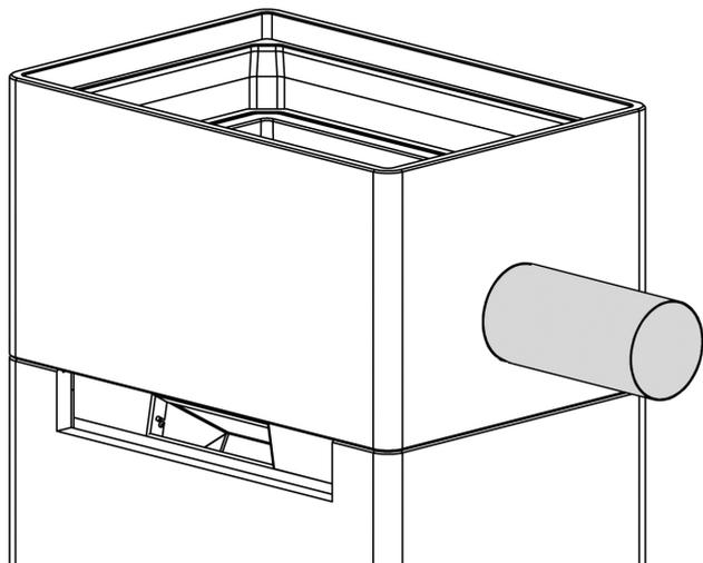
Tre røykrøret på plass. Før neste Powerstone legges på plass. Bruk pakning og forsikre deg om at tilkoblingen mellom rør og innerkjernen i Powerstone er tett. Røykrøret skal være flush med innsiden av Powerstone.
