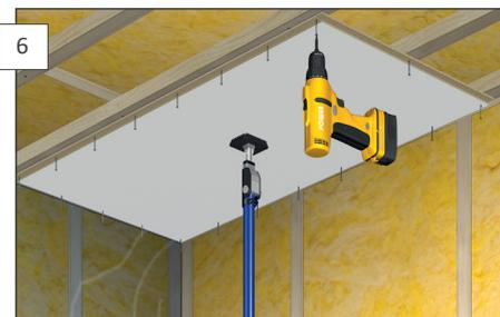
Forestia Premium Ceiling skrues i noten med Forestia treskruer 3,0/35mm. Skrueravstand cc 150mm. Kramper kan også benyttes. De skal ha rett rygg, min. 10mm bredde og lengden på bena bør være min. 35mm. **NB!** Trykk på krampepistol må justeres nøye. Kramper/skruer skal ikke dykkes, men flukte med overflate i nota.
