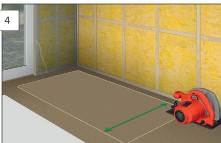
Platene monteres i full bredde fra første platerad, men renskjær platen ved å fjerne profilen. Vær skånsom mot platens profil.
