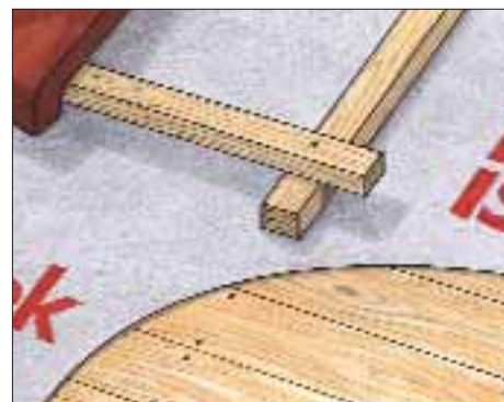
Pro Super som underlagsbelegg på bærende taktro av rupanel
