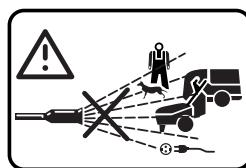
Den Wasserstrahl nie auf Menschen, Tiere, das Gerät oder elektrische Teile richten.
