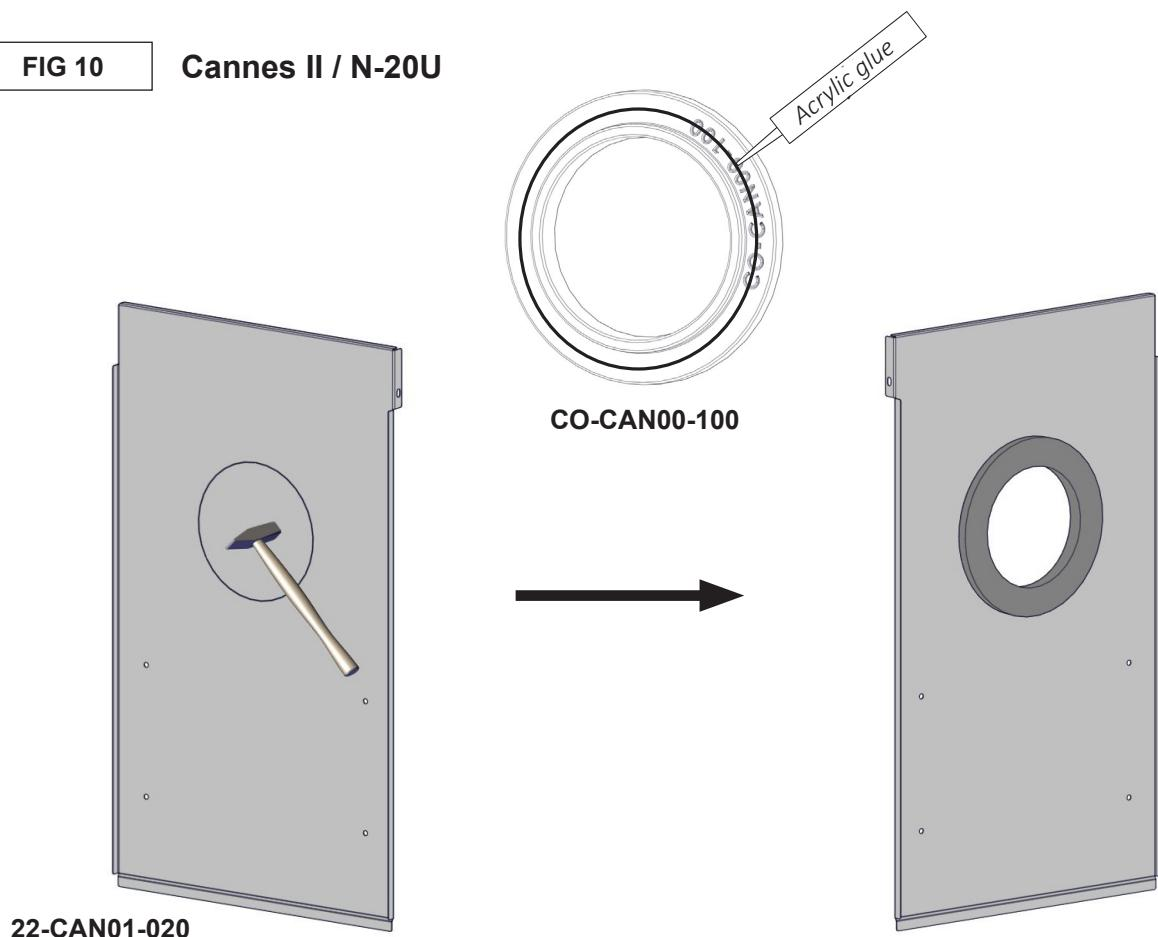
**NO:** Hvis du skal bak montere ildstedet Må du ta hull igjennom perforeringen og plassere betong ring mellom plate og tilstøtende vegg som vist på tegning bruk medfølgende akryl lim for å feste den.
