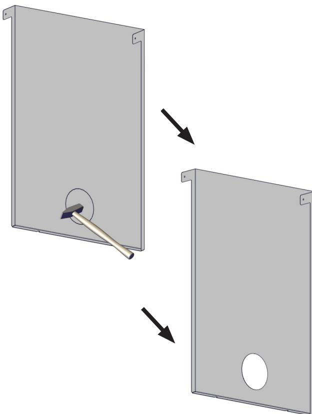
**NO: NB!** Hvis du skal bruke bakre lufttilkobling fjern den perforerte platen som vist i figur 5.
