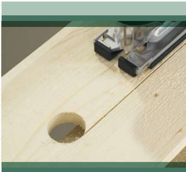
1. Understell: Skjære ut åpning til gripehåndtak
