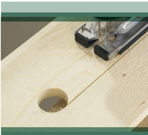
1. Understell: Skjære ut åpning til gripehåndtak
