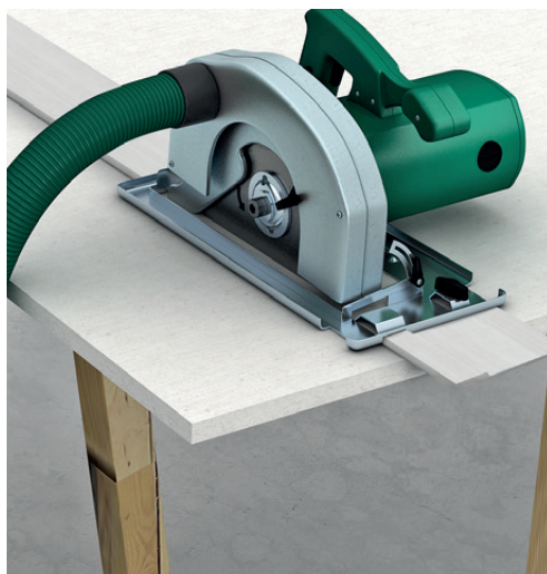
3. Skjæring med sirkelsag og skinne
