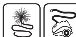
Kanalerna rengörs invändigt med lämplig kanalborste. Kanalerna är tillgängliga genom ventilfästen eller från fördelningsboxens servicelucka.
