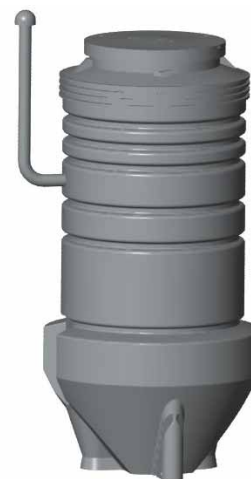
Fig. 15 Brønd med udluftningsrør
