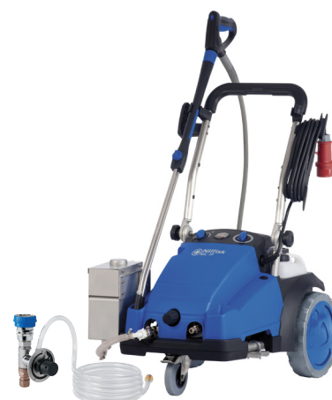
MC 7P FBFA med rustfri stålramme og svertefrie hjul og slange, flotørtank samt ekstern skuminjektor med omløp.
