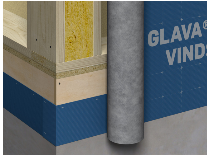
Fig. 28 Innfestet svillemembran før montering av vindsperre
