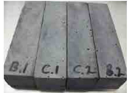
Svart : Jernoksid svart 3 % av sementvekt ( B1,C1), 5 % av sementvekt (C2,B2)
