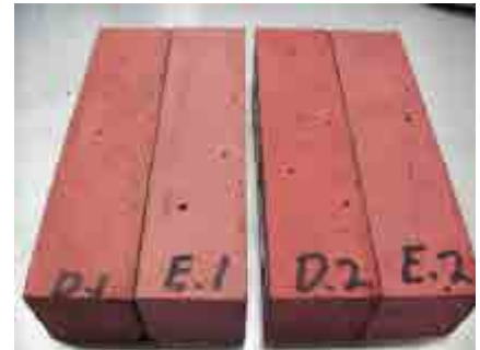
Rød : Jernoksid mellomrød 3 % av sementvekt ( D1,E1), 5 % av sementvekt (D2,E2)
