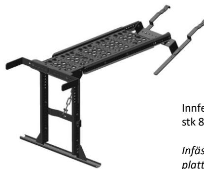
Innfestebøylene skrues til bøyel på plattform med 2 stk 8 x 20 mm sekskantskruer m/mutter.
