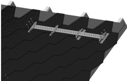
Før alle festebøylene inn på skinnen. Neoprenpakninger limes under hullene mot taket på de ytre festebøylene, og bøylene skrues fast over taksperrene med 3 stk 6,5x80 mm rustfrie skruer.
