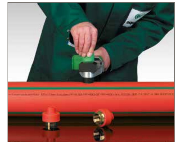
Oppvarming av rør og rørdel
