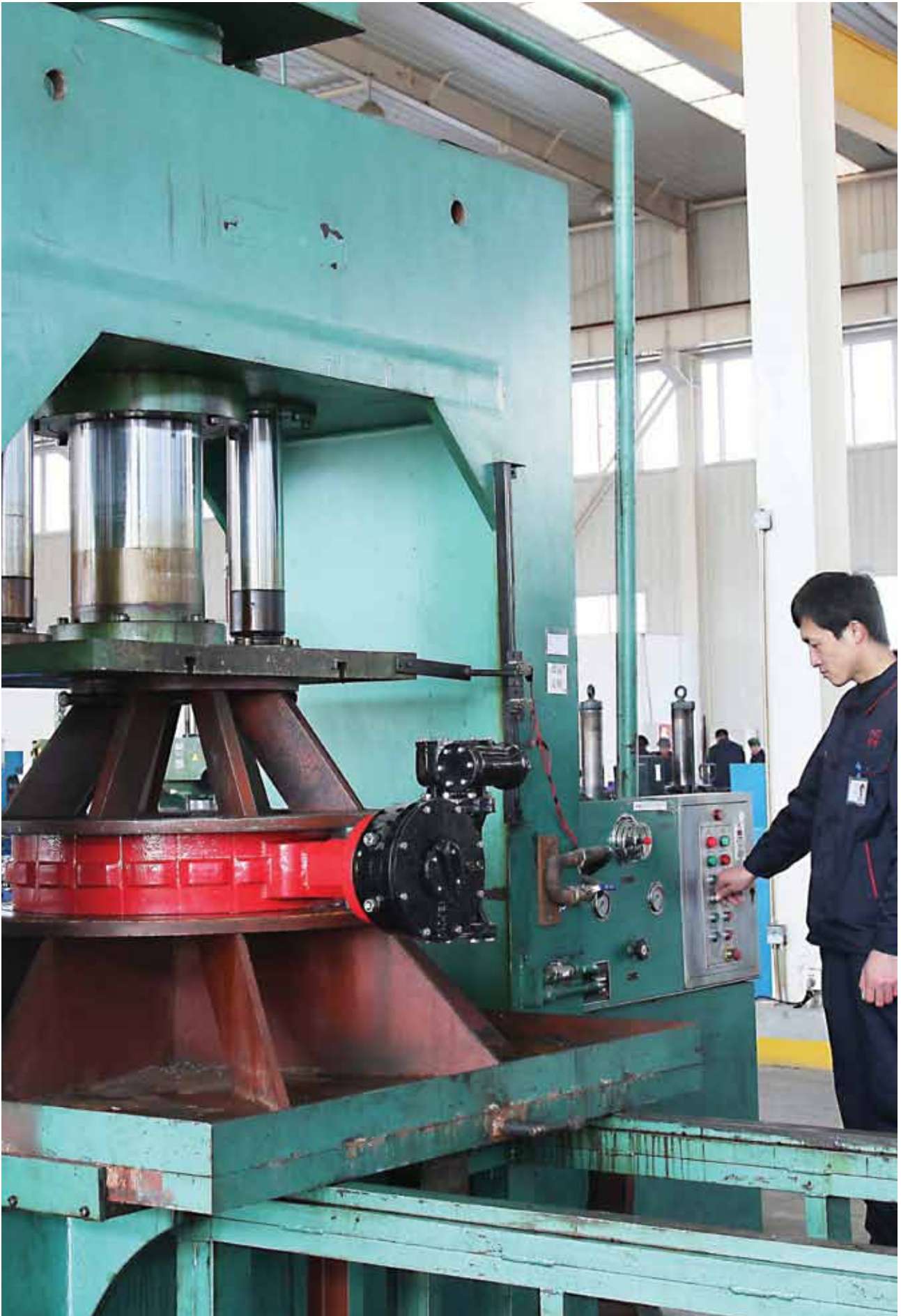
Alle ventiler er tryktestet fra begge sider/ All valves are pressure tested from both sides
