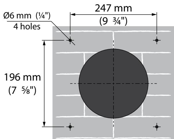
3. Sätt in de medföljande expandrarna 6 x 40 i hålen.
