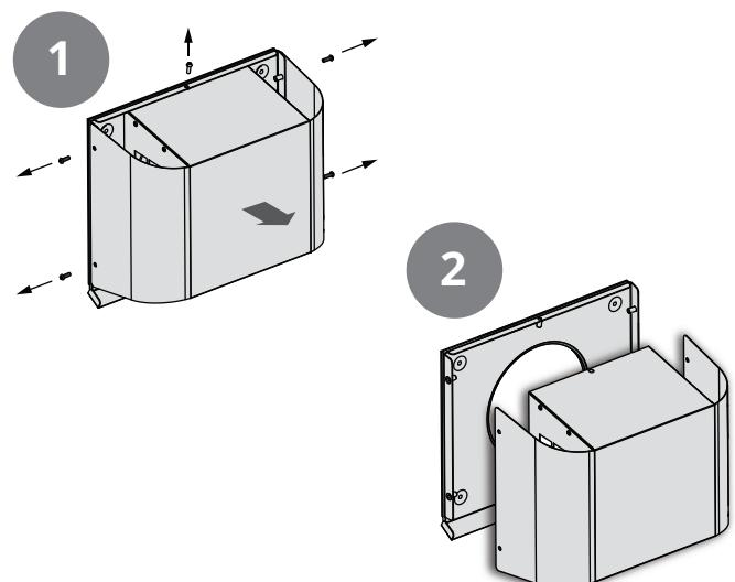
4. Kiinnitä ilmanvaihtokuvun takaseinä seinään mukana toimitetuilla ruuveilla 4x40.
