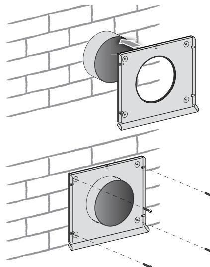
5. Täck ventilationskåpan med den främre delen.
