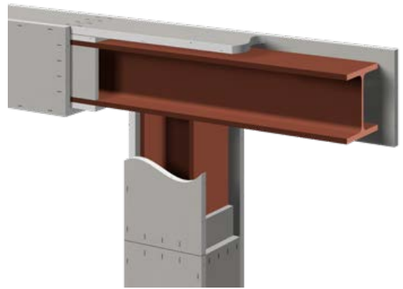
Bjelke kledt på 3 sider, understøttet av søyle kledt på 4 sider.
