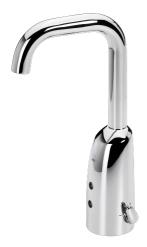
Berøringsfri servantkran med temperaturratt. Batteridrevet med 6 V batteri. Lengden på tuten er 120 mm.
