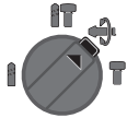
치줄 위치를 변경하기 위한 Vario-Lock 위치 이 위치에서는 모드 선택 스위치 11이 걸리지 않음.
