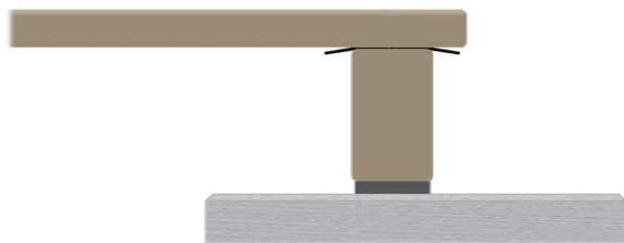
Eksempel på bruk av fuktbrytende sjikt. Distanseskloss mellom betonghelle og bjelke. Tilpasset svillepapp mellom bjelke og terrassebord.
