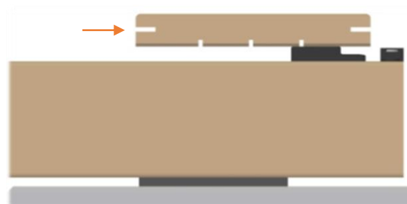
Figur 3: Monter bordet på underkonstruksjonen og skyv leppene inn i holderne.
