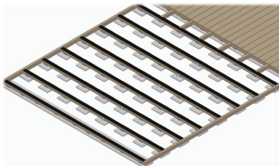
Bjelkelagstape benyttet mellom terrassebord og bjelker.
