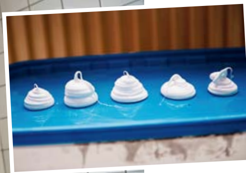
Smarriga maränger? Tyvärr inte, utan ett resultat av att plattsättarna provade hur mycket silikon ett tryck gav.
