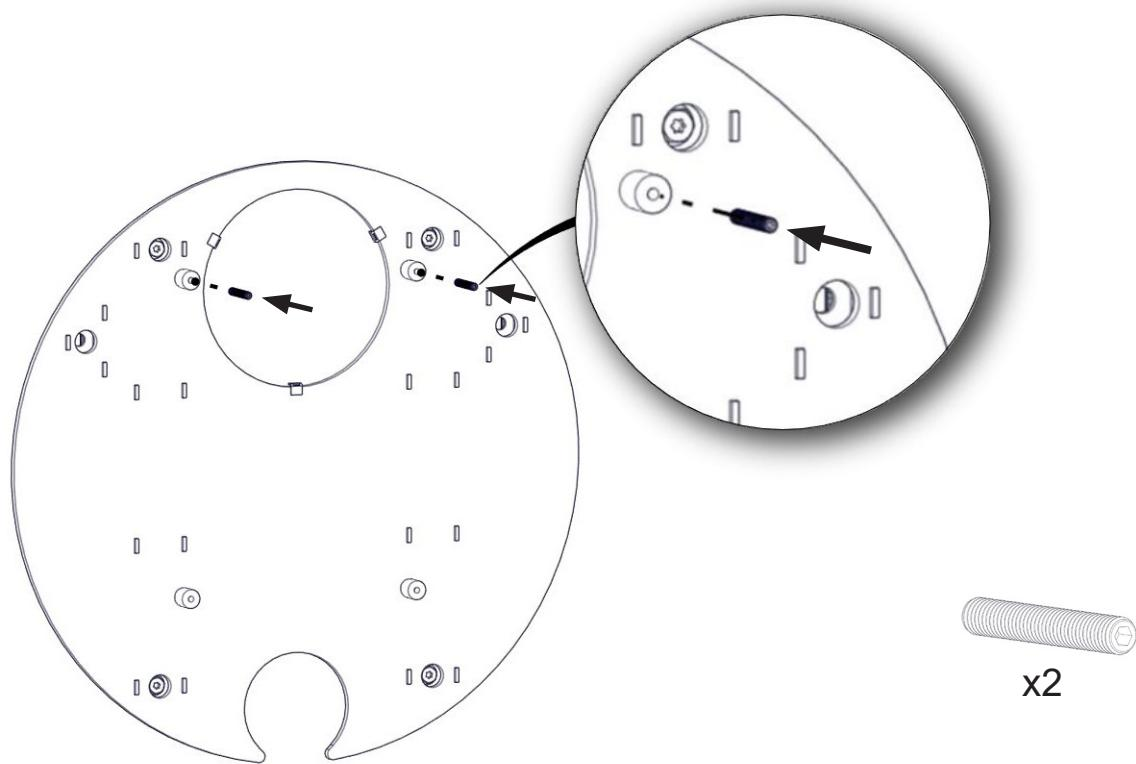
Se i monteringsanvisningen for ME og fjern Thermotteplatene fra brennkammeret. Skru ut de fire M8 blindsksruene i bakveggen inne i brennkammeret (Fig. 4). Skru de to medfølgende M6x40 gjengejernene inn i de to øverste festehullene i veggplaten (Fig. 3), slik at de blir stående ca 30mm ut fra veggplaten.
