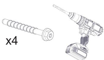
**NO** Hold veggplaten mot pipen / veggen og merk av for festehullene (Fig.2A eller 2B). For bakmontering av røykrør fjernes blindlokket for røykrør og eventuelt frisklufttilkobling i veggplaten, før også disse hullene merkes av på veggen. Bruk et 8mm murborr. Borreddybde skal være 90mm, og alt støv og løse biter må fjernes fra hullene. Ved bakmontering tas det også hull for dette.
