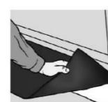
**NO:** Dersom underlaget er betong må det plasseres en fuktspærre under terskelen, for eksempel tjærepapp.
