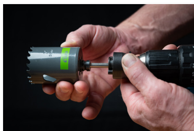
2. Enkle å bytte. Trekk holderen bakover og slipp når hullsagen er på plass.
