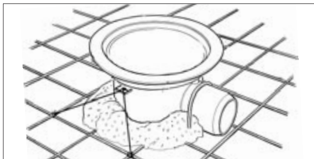
Sluket bindes til armeringen
