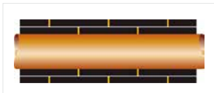
Gule streker viser limte skjøter
