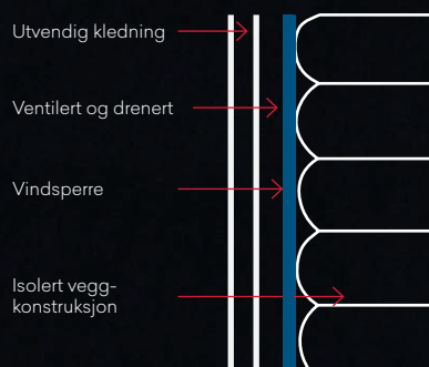
To-trinns tetting med luftet kledning
