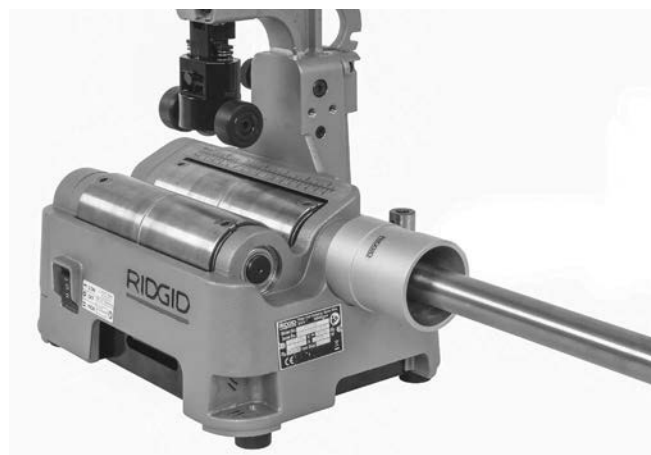
Figur 12 – Fjerning av grader i rør
