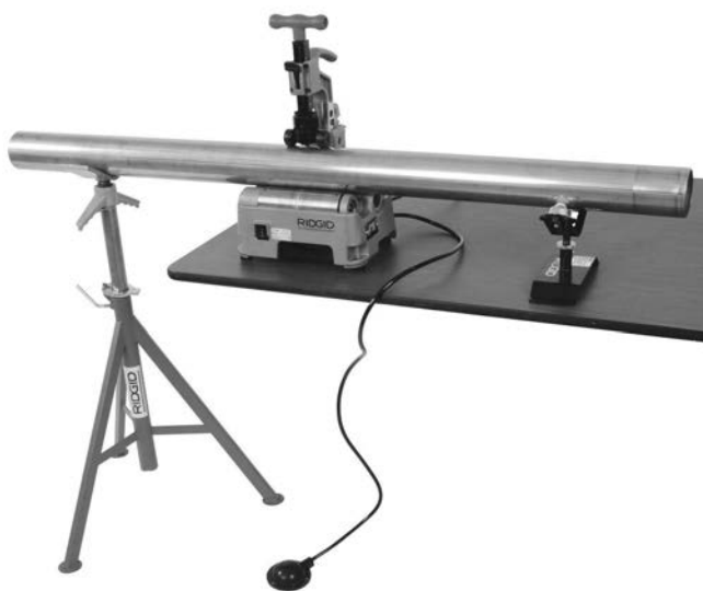
Figur 3 – Plassering av stativ
