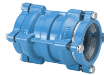
Skjøtemuffe DN 50-350 Ved å fjerne stoppringen kan den brukes som glide- muffe.
