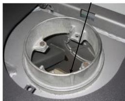
Markering av kondensavløp.
