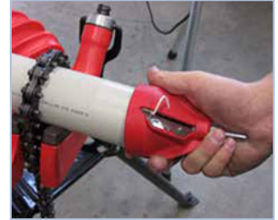
Fase enden av røret.
