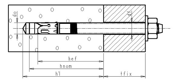
$h_{ef}$ : effective anchorage depth  $h_{nom}$ : embedment depth  $h_1$ : drilling hole depth  $t_{fix}$ : fixture thickness
