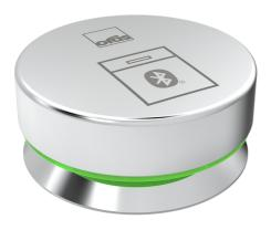
Oras elektronisk avstengningsventil for oppvask – eller vaskemaskin. Produktet består av en trådløs Smart trykk-knapp, en kontrollenhet og en elektronisk ventil. Ventilen er åpen i 4 timer. Det er mulig å forlenge åpningstiden til 12 timer ved å holde knappen inne i lenger enn 5 sekunder. Nettdrift via plug-in transformator (230/5 V).
