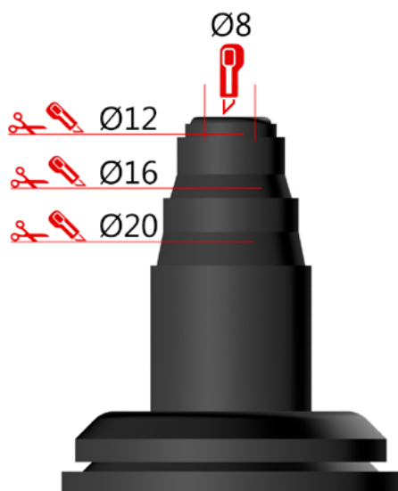
Kapping av rørgjennomføring
