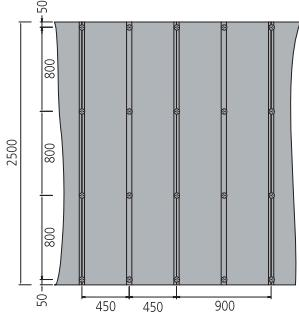
Montering: 450 mm pigg med festeplater og skruer for BA12,5 mm.
