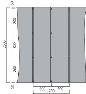
Montering: 600 mm pigger med festeplater og skruer for BA30; BA50 mm.
