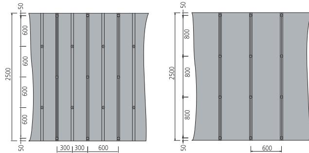
Montering: 300 mm pigg med festeskiver og skruer for BA 10; BA 12,5 mm.
