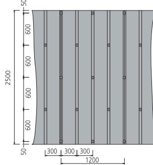
Montering: 300 mm pigg med festeplater og skruer for BA12,5 mm.
