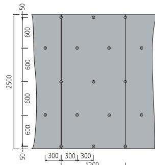
Montering: Full overflate liming og plugger for BA12,5; BA30; BA50 mm.
