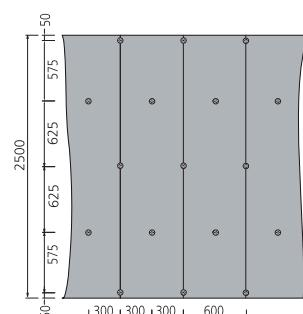
Montering: Full overflate liming og dyveling fra BA 04 mm.
